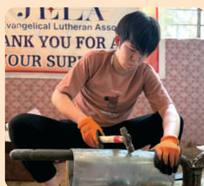
義足は1枚のアルミ板を切り出して作られます
